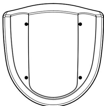
Fixation 4x  $\varnothing$  5 sur  $\varnothing$  212
